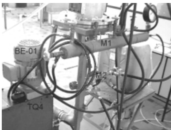
Figura 5 Detalhes do manifold de óleo "M1" e do manifold de água "M2".
